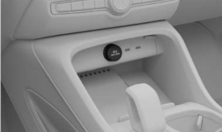
Ổ cắm điện 12 V trong bảng điều khiển đường hầm
