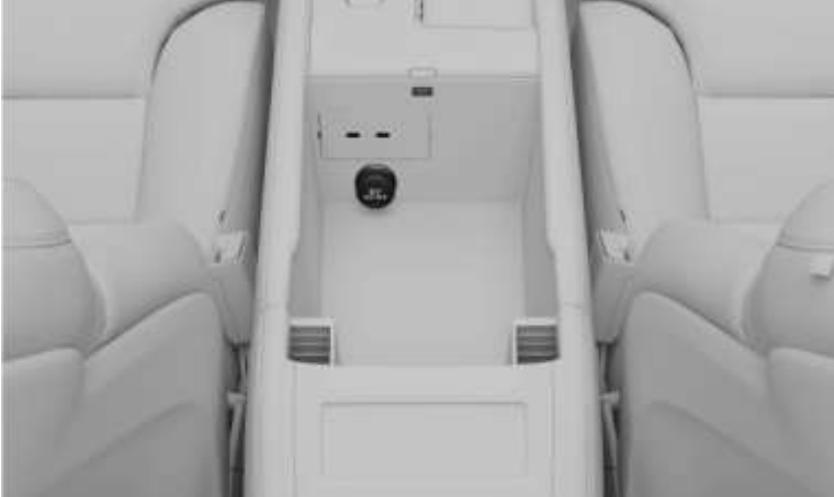
Ổ cắm điện 12 V trong Bảng điều khiển giữa xe
